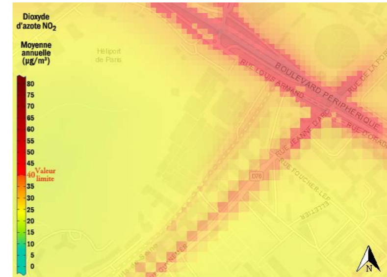
Figure 47 : Bilan annuel des concentrations en NO 2 au niveau de l'Aquaboulevard en 2021 (Source : AirParif)
