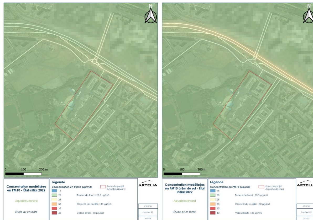
Figure 52 : Contribution des sources modélisées aux concentrations moyennes annuelles dans l'air en PM 10 en µg/m 3 à 1m50 du sol à gauche et 8m du sol à droite (Source : Etude air et santé, Artelia, 2023)
