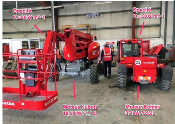
Installation d'AntiSmog sur un moteur (gauche) Engins de chantier LOXAM sur lesquels AntiSmog a été testé (droite) Source : Net SAS
