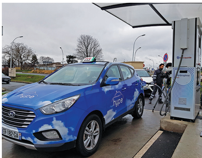
Avitaillement d'un taxi dans une station hydrogène
