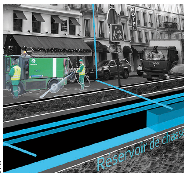
État projet : connexion des gouttières vers les réservoirs de chasse des égouts
