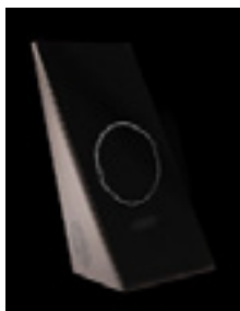
— Lidars 3D de la société Outsight permettant de suivre un flux de personnes en mesurant la distance, la taille et la forme des objets.
