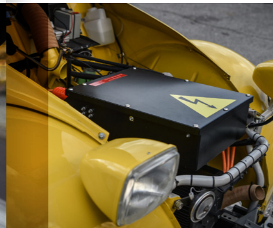
La technologie du retrofit consiste à remplacer, dans un véhicule existant, un moteur thermique par un électrique.
